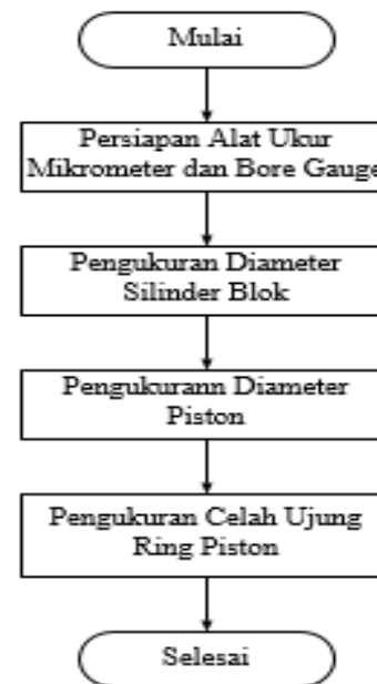
Gambar 15. Diagram Alur Proses Pengukuran Silinder Blok, Piston Dan Celah Ring Piston
