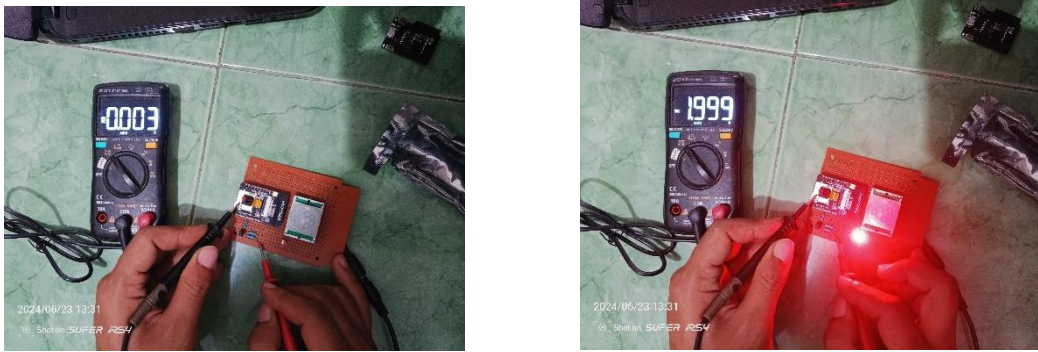
Gambar 15. Pengujian Passive Infrared Receiver dengan Avometer
