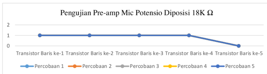
Gambar 12. Grafik Hasil Uji Coba dimana Mikrofon, diatur oleh Potensio ke-18K \Omega .
