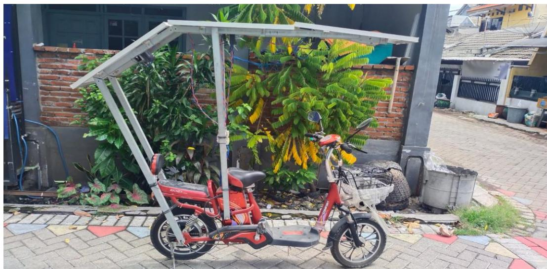
Pada gambar terlihat posisi panel surya berada diatas pengemudi dan menghadap keatas untuk mendapatkan sinar matahari secara optimal untuk sumber daya listrik yang digunakan untuk menggerakan motor. Proses pengujian dilakukan dengan menggunakan perangkat yang diimplementasikan pada kondisi cahaya pagi, siang dan sore hari.
