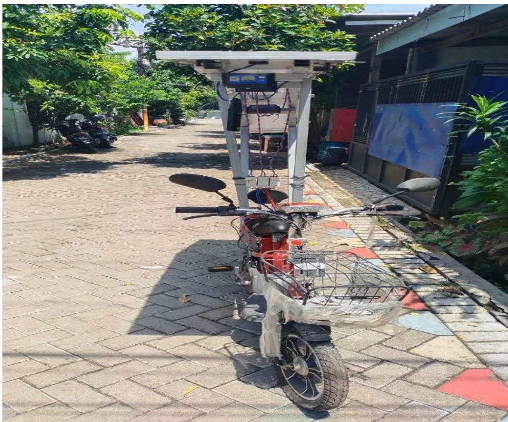
Pada gambar posisi baterai dan komponen lainnya berada dibawah panel surya untuk memudahkan pengujian pada pengisian daya baterai. Dan juga untuk memudahkan focus pengemudi dalam berkendara. Diporelah hasil pengujian pada pengisian baterai saat kosong dengan PLN.
