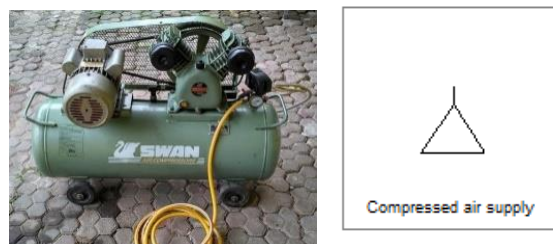
Gambar 4. Air Compressor dan Simbol Air Compressor Pada Diagram
