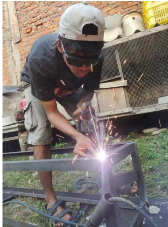
Gambar 4. Proses perakitan dudukan mesin pres
