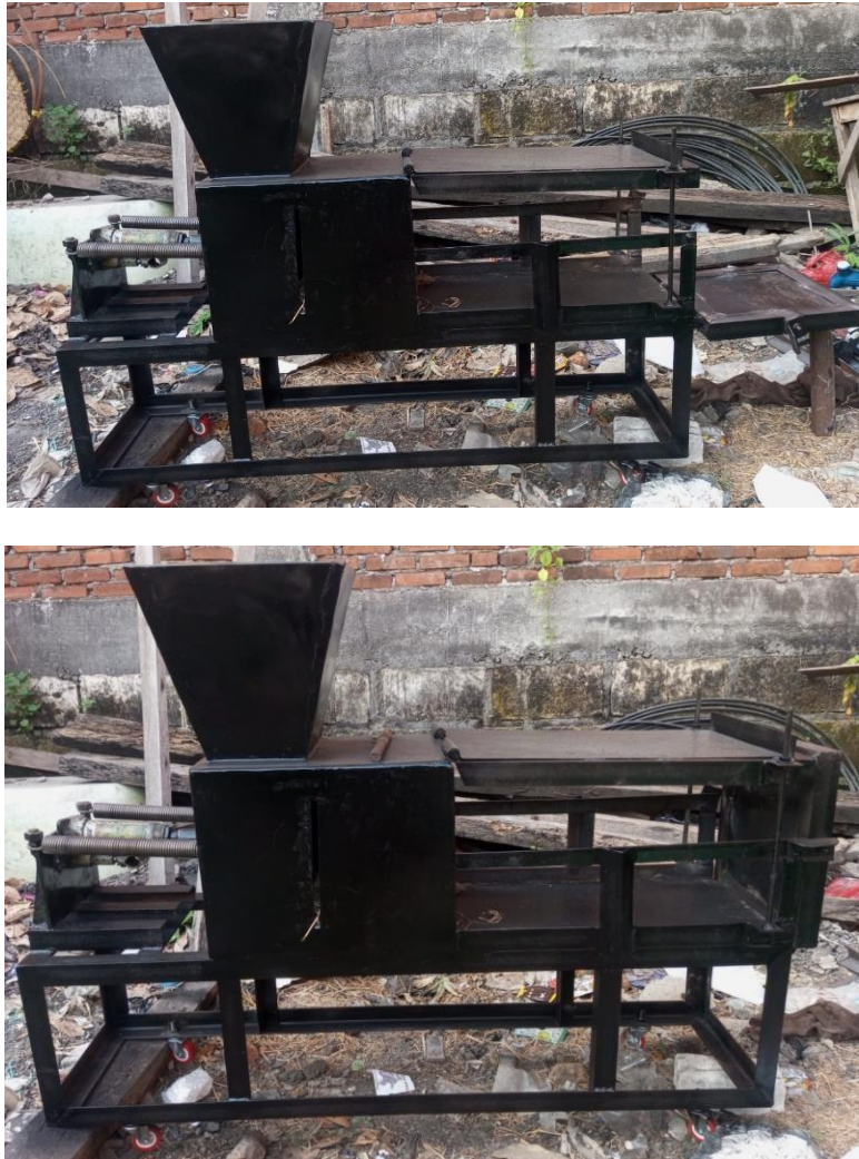
Gambar 7. Hasil erection prototabe mesin pengepres jerami dengan sistem hidrolik
