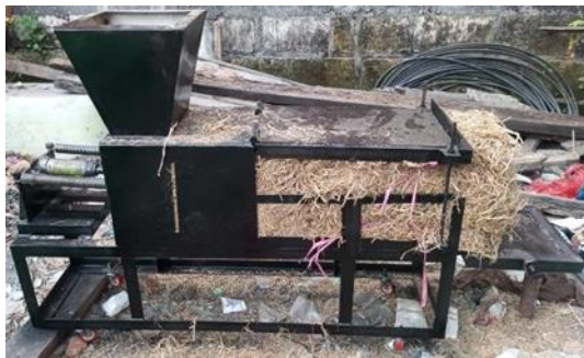
Hasil pengujian dengan jarak alas pengepres 30cm
