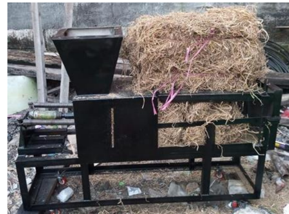
Hasil pengujian dengan jarak alas pengepres 25cm
