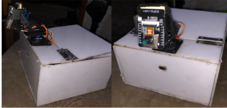
Gambar 4. Hasil realisasi alat pendeteksi kebisingan
