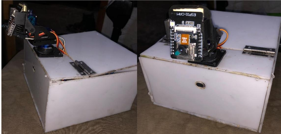
Perakitan alat dilakukan dengan box putih yang dimodifikasi dengan penambahan engsel untuk memudahkan penempatan komponen elektrik berupa powerbank sebagai supply daya dan mikrokontroler NodeMCU ESP8266 kedalamnya. Pada bagian atas box terpasang tilt servo dan ESP32-Cam yang dapat dikontrol pengguna dalam menangkap gambar dari beragam arah. Bagian depan box dilubangi sebagai lokasi penempatan sensor GY MAX4466 untuk mendeteksi bunyi kebisingan.
