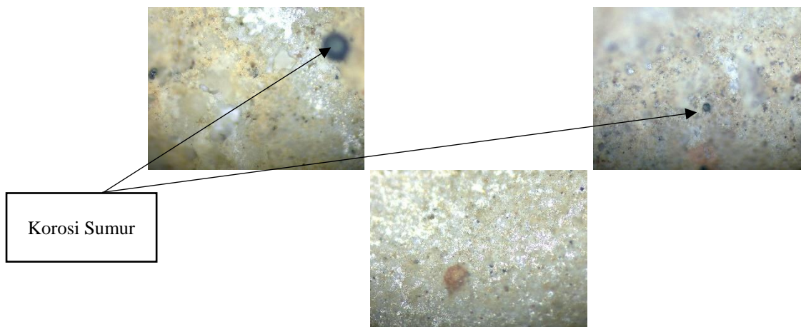
Gambar 8. Hasil Uji Mikro Plat And Gasket Heat Exchanger yang direndam dengan cairan merah..
