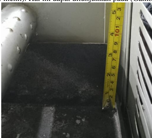
Gambar 7. Tinggi pemasangan arang yang disarankan (5-6 cm)
