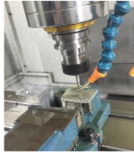
Gambar 15. Proses Pemotongan Spesimen
