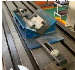
Gambar 13. Posisi spesimen pada jig
