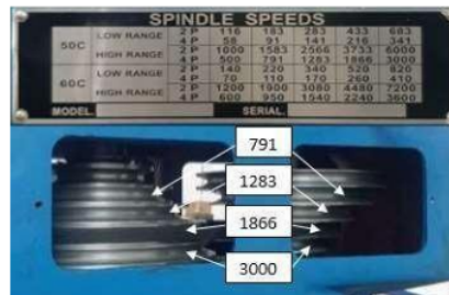
Gambar 12. Setting kecepatan putaran spindle
