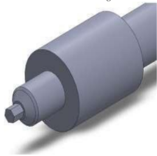
Gambar 1. Desain Tool FSW
