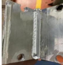
Gambar 14. Hasil spesimen friction stir welding
