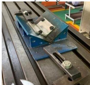
Gambar 13. Posisi spesimen pada jig
