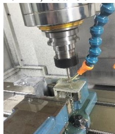
Gambar 15. Proses Pemotongan Spesimen
