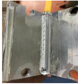
Gambar 14. Hasil spesimen friction stir welding
