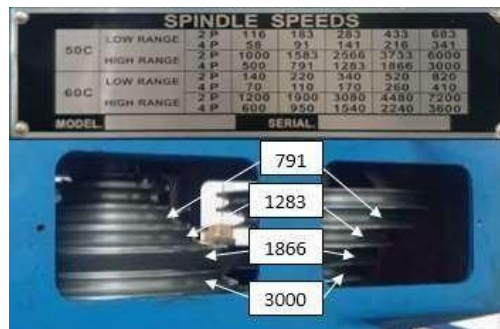
Gambar 12. Setting kecepatan putaran spindle
