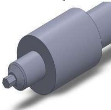
Gambar 1. Desain Tool FSW
