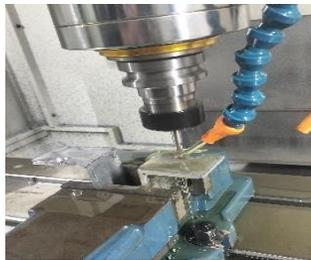
Proses Pemotongan Spesimen
