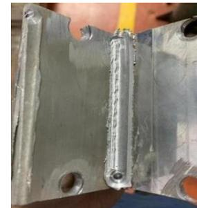
Hasil spesimen *friction stir welding*
