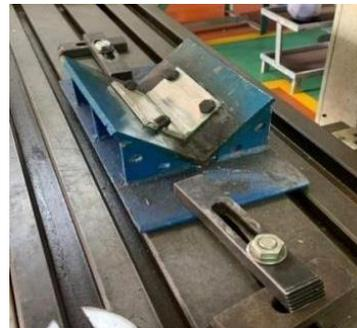
Posisi spesimen pada jig
