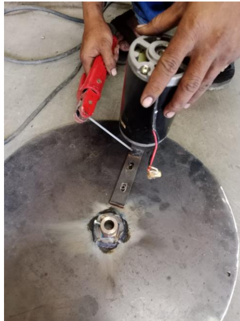
Gambar 3. 8 Pemasangan dudukan Generator
