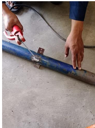
Gambar 3.1 Pengelasan sproket di poros
