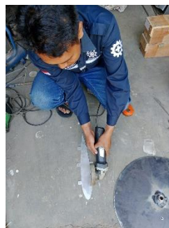
Gambar 3. 2 Pemotongan plat alumunium
