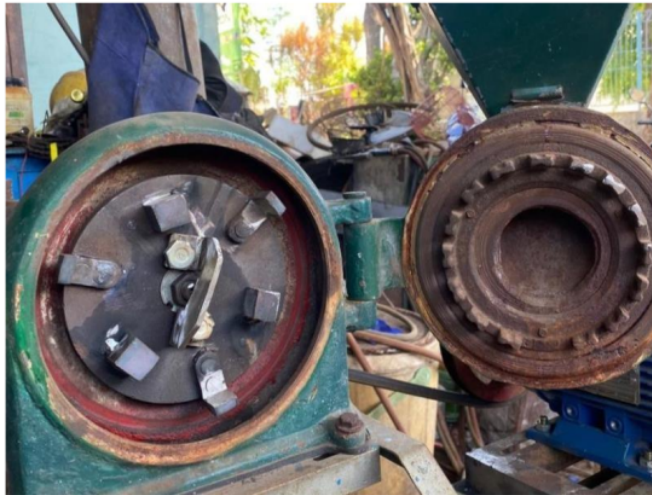
Gambar 8 Assembly Pisau Pada Mesin
