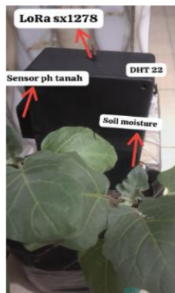
Gambar 4. Pengujian alat transmitter pada tanaman terong
