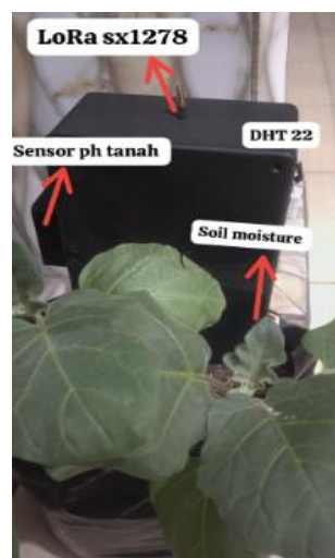
Gambar 4. Pengujian alat transmitter pada tanaman terong
