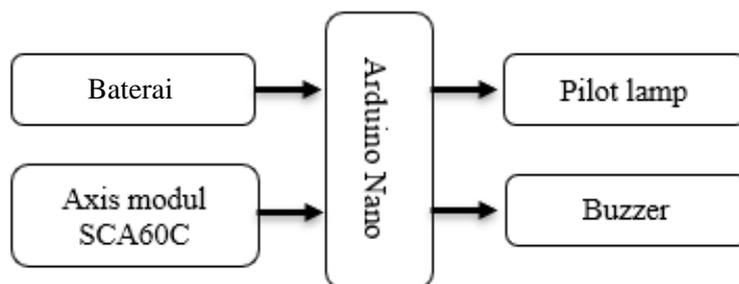
Gambar 1. Blok Diagram
