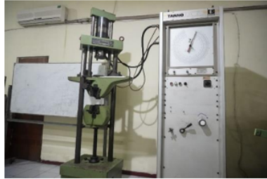
Gambar 2. Mesin Uji Tarik
