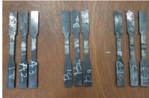
Gambar 9. Spesimen material SPHC
