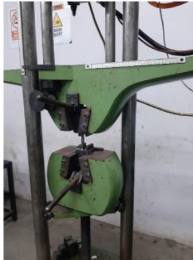
Gambar 10. Proses Pengujian Tarik Spesimen
