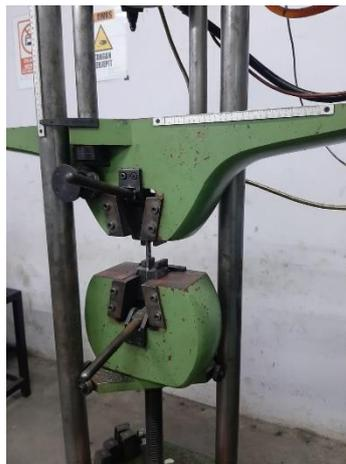
Gambar 10. Proses Pengujian Tarik Spesimen
