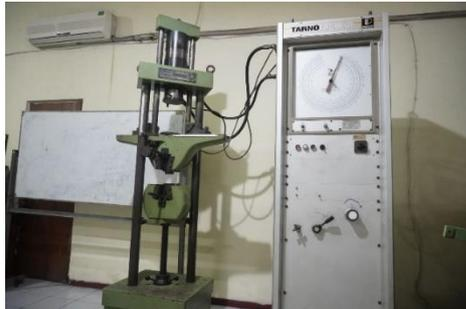
**Gambar 2.** Mesin Uji Tarik
