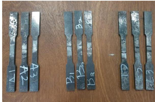
**Gambar 9.** Spesimen material SPHC
