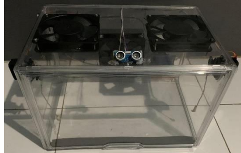
Gambar 4. Realisasi desain otomasi buka tutup pintu almari sepatu berbasis arduino uno
