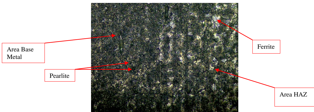
Gambar 3.2 Perbatasan antara HAZ dan Base Metal
