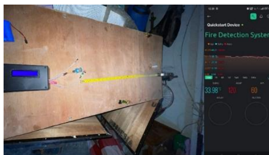
Gambar 14 Pengujian sensor ketika tidak terjadi kebakaran
