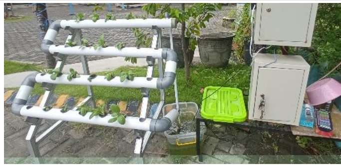
Gambar 3 Alat pengolahan citra Pada Tanaman Pakcoy hidroponik untuk Mendeteksi Kadar Nutrisi AB MIX
