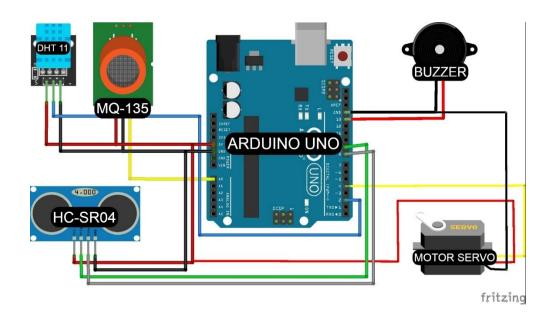
alat Pengkabelan berpusat pada mikrokontroler Arduino Uno dimana sensor MQ-135 terhubung dengan pin A0, lalu sensor DHT11 terhubung dengan pin D2, sensor HC-SR04 terhubung ke pin D9 untuk TRIG dan D8 untuk ECHO, lalu pin PWM D4 terhubung dengan motor servo, terakhir buzzer terhubung dengan pin D13.
