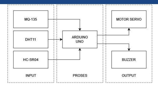
Penelitian memanfaatkan tiga input sensor yaitu sensor MQ-135 sebagai pendeteksi gas ammonia sebagai indikasi bau, sensor DHT11 untuk suhu dan kelembapan, serta sensor HC-SR04 sebagai pendeteksi jarak pengguna dalam kontrol buka tutup tempat sampah. Data pembacaan ketiga sensor tersebut lalu diproses oleh mikrokontroler Arduino Uno R3. Komponen output berupa motor servo untuk kendali buka tutup tempat sampah serta buzzer sebagai alarm.
