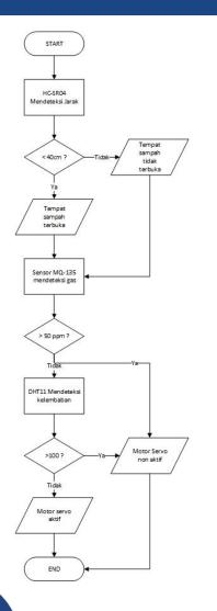
Ketika ada objek yang mendekat di depan tempat sampah maka sensor ultrasonik HC-SR04 akan mendeteksi jarak dari objek ke sensor.
