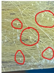
Gambar 5. Void Yang Terkandung didalam Spesimen
