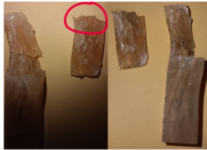
Gambar 8 Patah Getas Spesimen Uji Tekan
