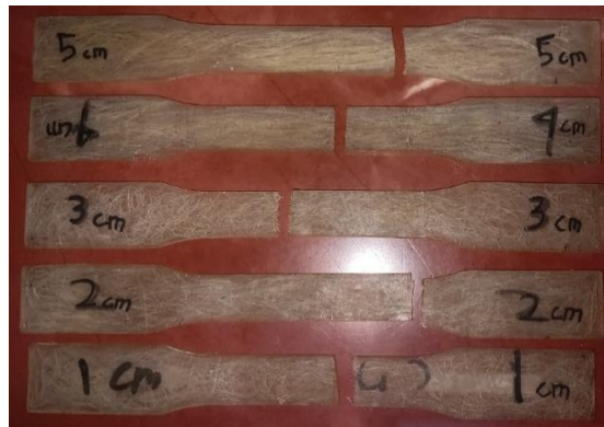
Gambar 1 Spesimen Setelah Uji Tarik
