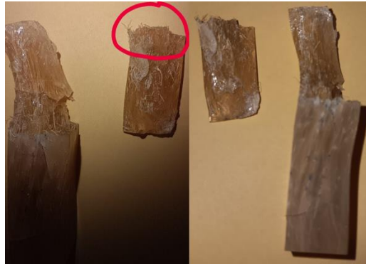
Gambar 8 Patah Getas Spesimen Uji Tekan
