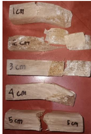
Gambar 6 Spesimen Uji Tekan Yang Telah di Uji
