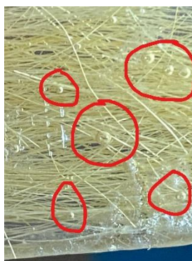
Gambar 5. Void Yang Terkandung didalam Spesimen
