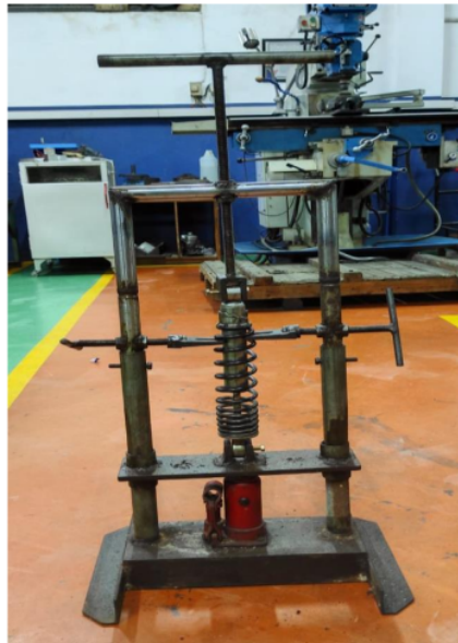
Gambar 3.7. Proses Pelepasan dan Pemasangan Pegas Shock Absorber
