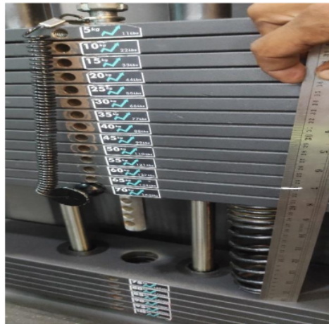
Gambar 3.8 Pengujian Spring Shock Absorber dengan Beban 70 Kg
