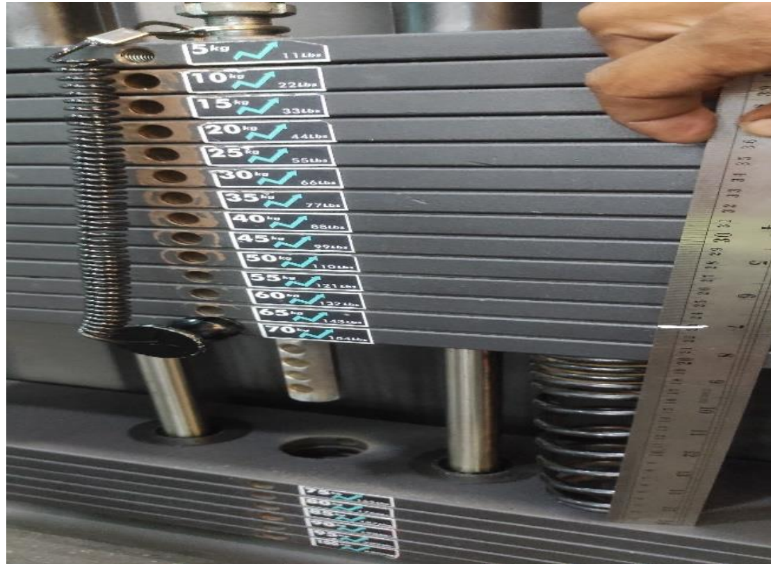
Gambar 3.8 Pengujian Spring Shock Absorber dengan Beban 70 Kg
