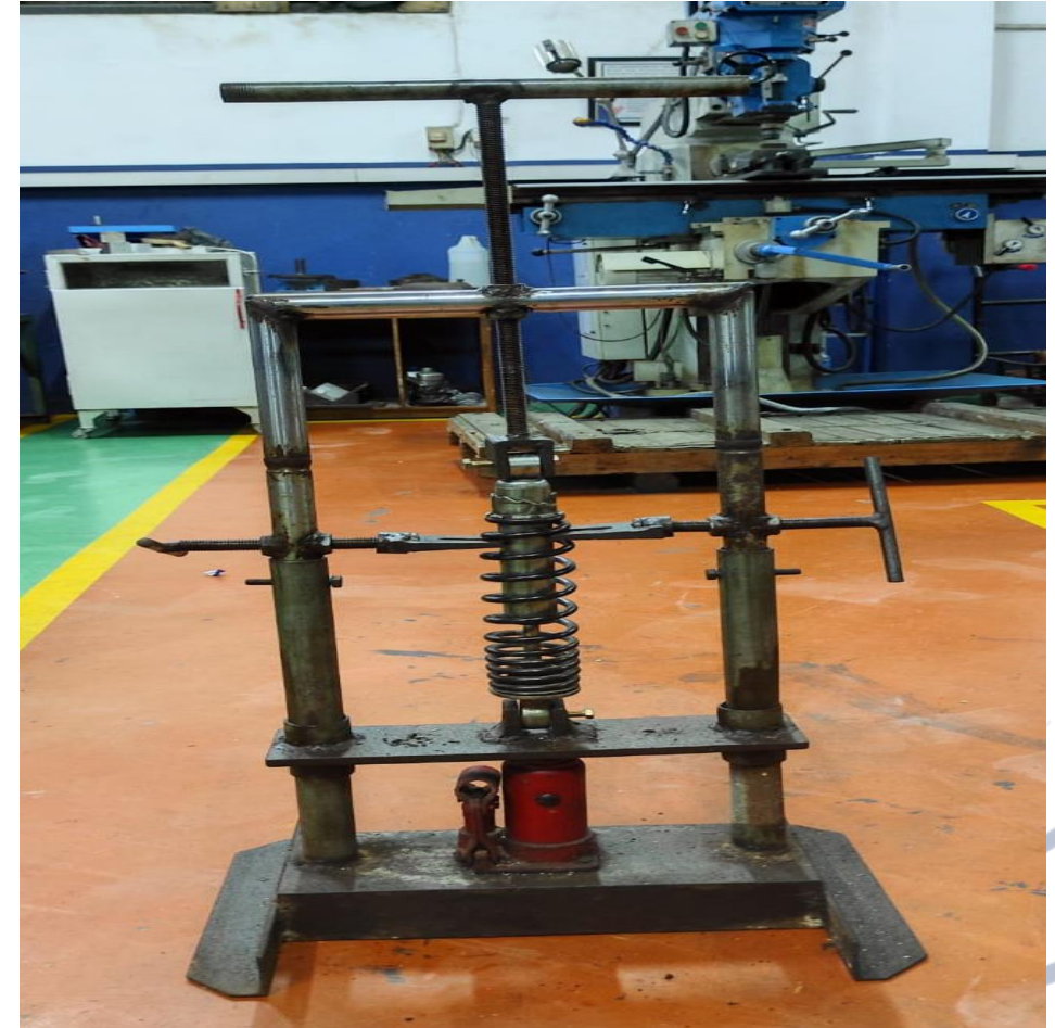
Gambar. Proses Pelepasan dan Pemasangan Pegas Shock Absorber
