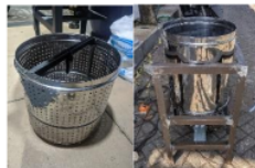
Gambar 5. Pemasangan Tabung Luar dan Tabung Dalam
