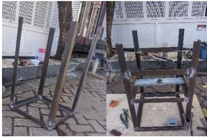
**Gambar 2.** Proses Pengelasan Rangka Mesin Peniris Minyak
