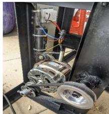
**Gambar 4.** Proses Pemasangan Motor dan Kelistrikan
