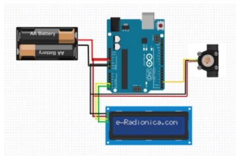
**Gambar 9.** Rangkaian untuk pembacaan flow air
