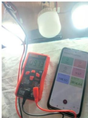
**Gambar 17.** Hasil Monitoring dengan beban 25W dan 10W
