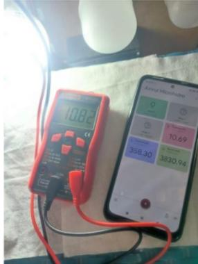
**Gambar 16.** Hasil Monitoring dengan beban 25W
