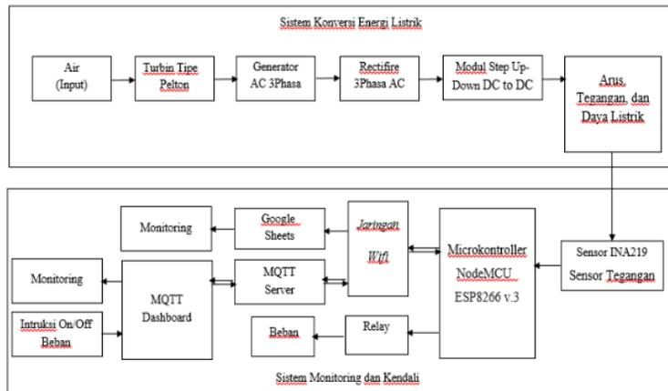
Gambar 7. Diagram Blok sistem konversi energi dan sistem monitoring dan pengendali beban
