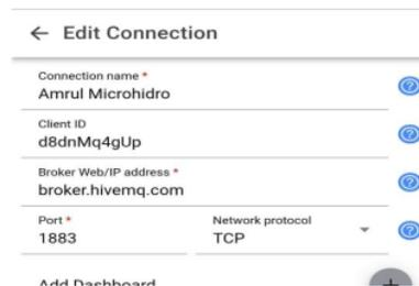
**Gambar 19.** Broker yang digunakan
