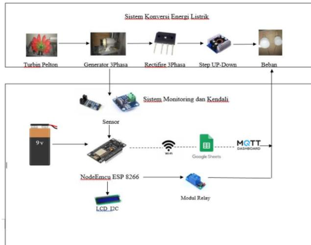
Gambar 10. Skema pembangkit listrik tenaga mikrohidro berbasis IoT
