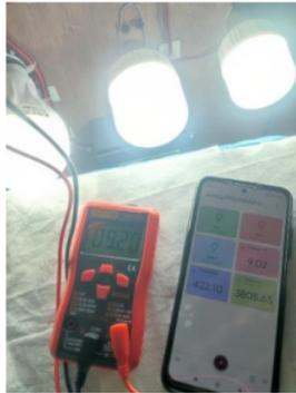
**Gambar 18.** Hasil Monitoring dengan beban 25W, 10W, 15W
