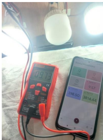
Gambar 17. Hasil Monitoring dengan beban 25W dan 10W Nilai yang diperoleh dari pengujian ke-dua saat kondisi Relay 1 dan 2 On dengan beban lampu sebesar 25 watt dan 10 watt adalah
