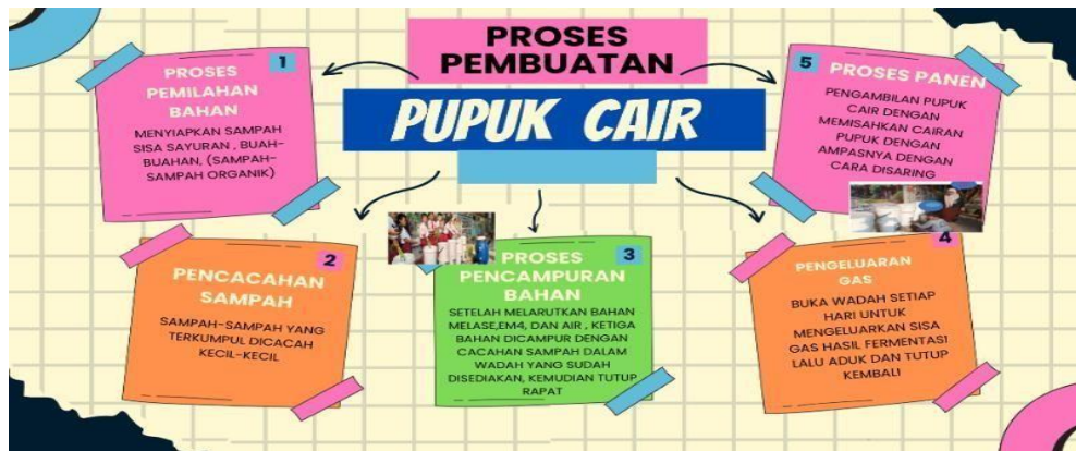
Gambar 1.4. skema proses pembuatan pupuk cair
