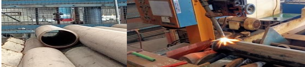
Gambar 12. Proses Pemotongan Pipa STPG370 SCH80 D125.
