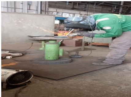
Gambar 13. Proses fit-up sebelum pengelasan
