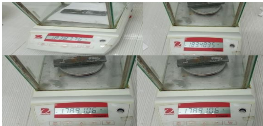
Gambar 18. Proses Penimbangan Pre-Test Uji Korosi Yang Dilakukan Di Lab. Teknologi Pangan UMSIDA.
