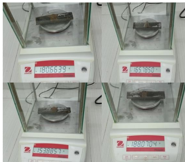
Gambar 20. Proses Penimbangan Pos-Test Uji Korosi yang Dilakukan di Lab.Teknologi pangan UMSIDA.
