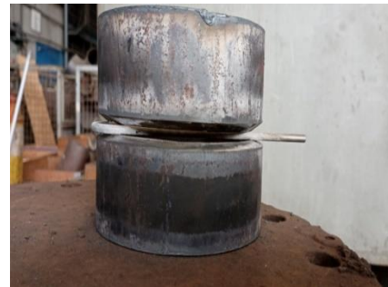
Gambar 13. Proses fit-up sebelum pengelasan
