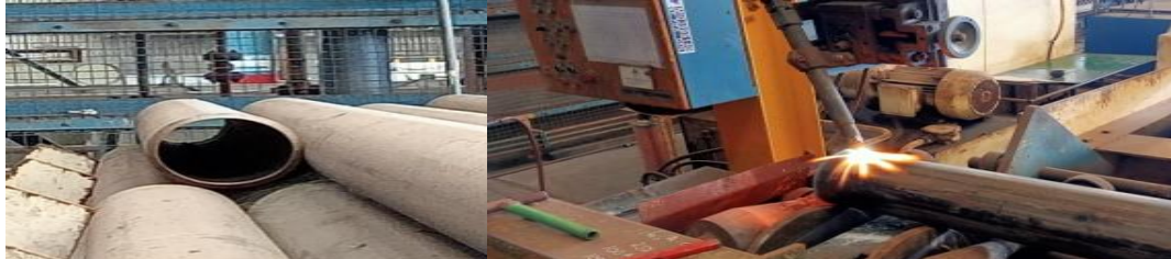
Gambar 12. Proses Pemotongan Pipa STPG370 SCH80 D125.
