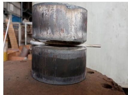
Gambar 13. Proses fit-up sebelum pengelasan
