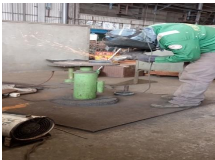
Gambar 13. Proses fit-up sebelum pengelasan
