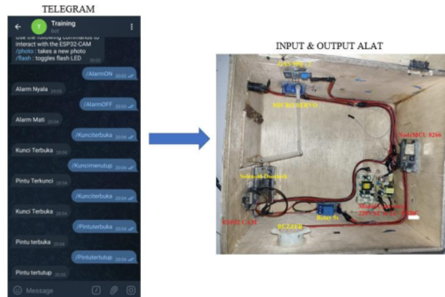
1 Gambar 5. Pengujian perintah chatbot ke input dan output alat
