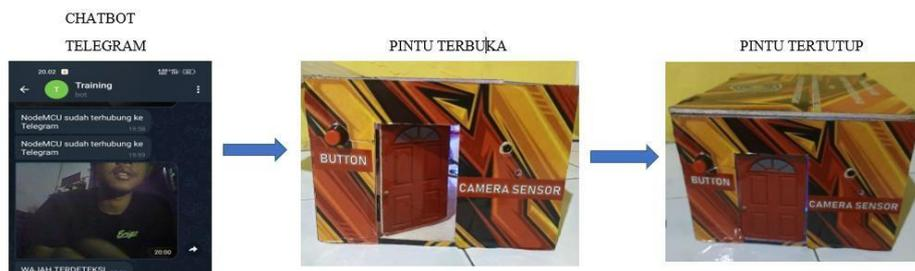
Gambar 3. Pengujian kamera ESP32 CAM pada alat
