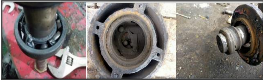
Gambar 7. Bearing mengalami kerusakan
