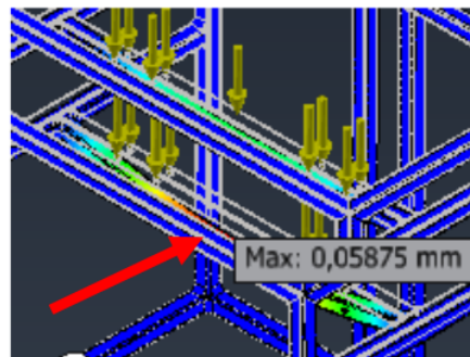
Gambar 15. Titik Maksimal Analisa Displacement pada Desain Rangka Mesin Poles
