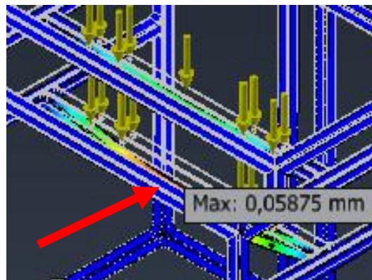
Gambar 15. Titik Maksimal Analisa Displacement pada Desain Rangka Mesin Poles
