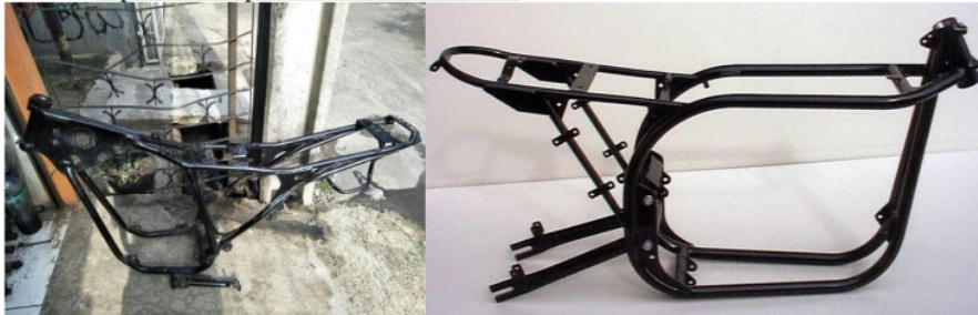
Gambar 3. Chasis bawaan pabrik (kiri) dan chasis kustomisasi (kanan)
