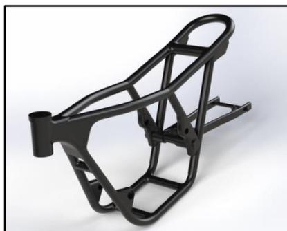
**Gambar 2.** Rancangan Desain Chasis Motor Roda Dua
