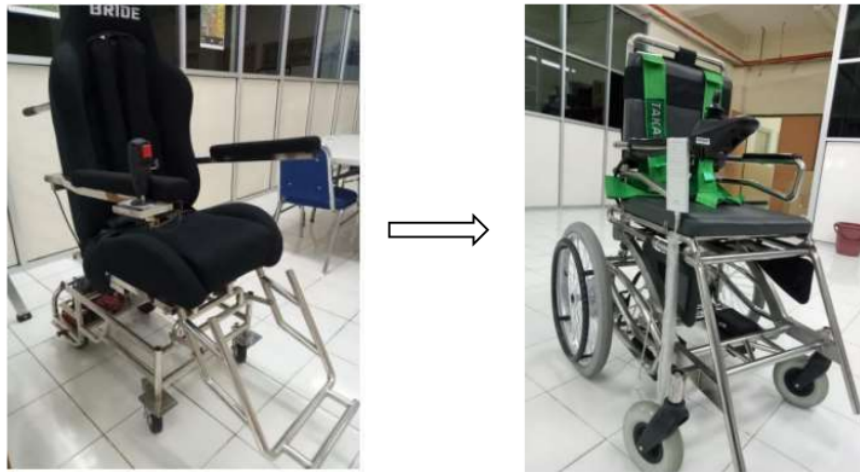
Gambar 2. Modifikasi kursi roda elektrik dengan penambahan adjuster
