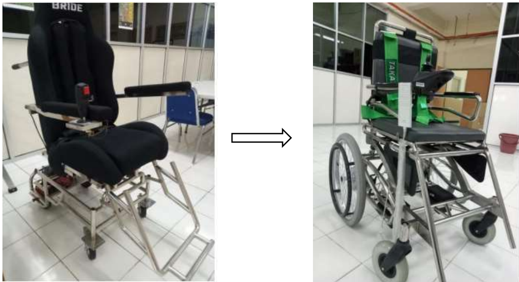
Gambar 2. Modifikasi kursi roda elektrik dengan penambahan adjuster
