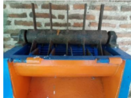
Gambar 9. Mata Pisau Sebelum Modifikasi pangkon pisau berdiameter 160 mm dengan ketebalan plat 8 mm
