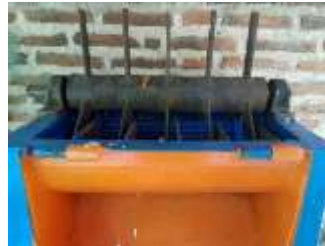
Gambar 9. Mata Pisau Sebelum Modifikasi pangkong pisau berdiameter 160 mm dengan ketebalan plat 8 mm
