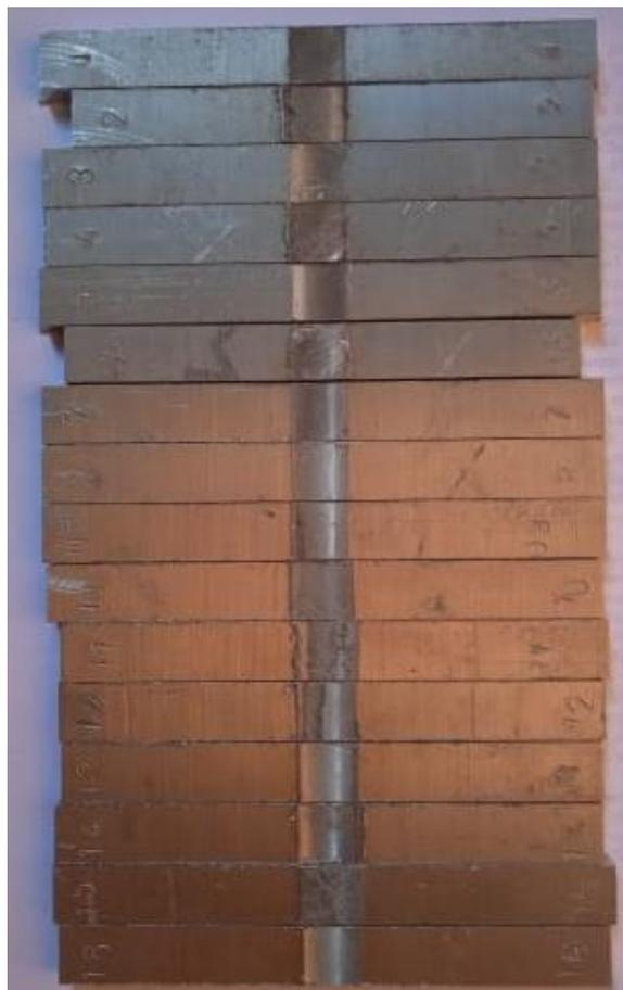
**Gambar 3.** Spesimen Uji Tekuk.
